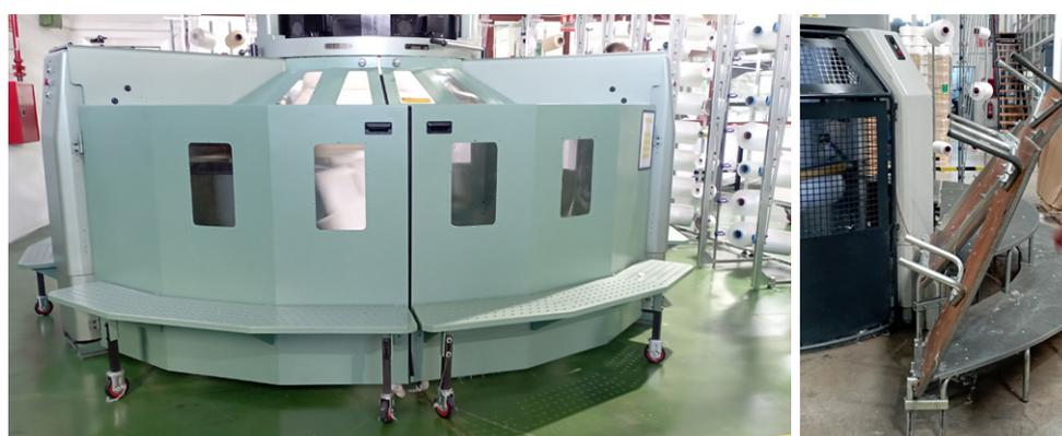
Figura 61. Plataforma retirable (Fuente: estudio de campo).
