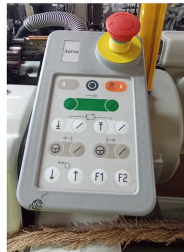
Figura 73. Mandos y controles de máquinas circulares (Fuente: estudio de campo).
