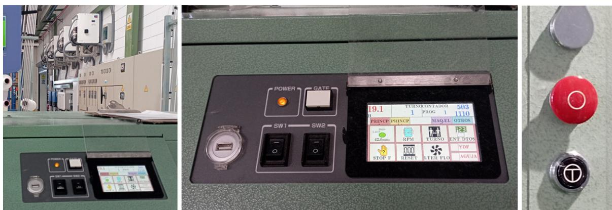
Figura 58. Mandos y controles de máquinas circulares (Fuente: estudio de campo).
