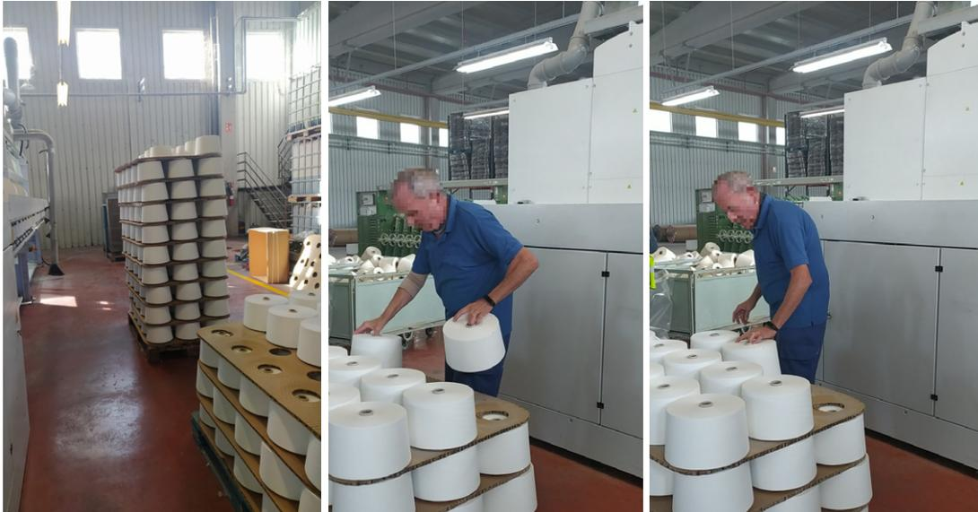
Figura 29. Paletizado de bobinas terminadas (Fuente: estudio de campo).
