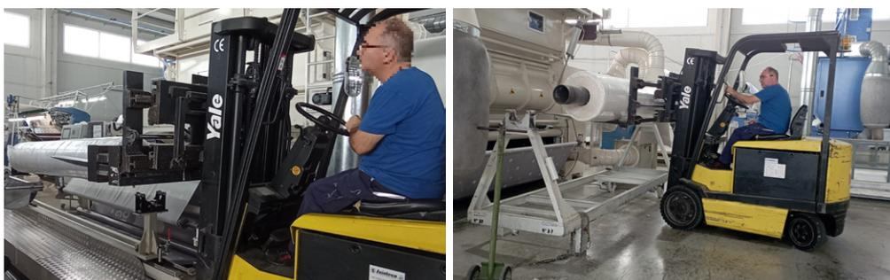
Figura 19. Empleo de medios mecánicos para la alimentación de rollos (Fuente: estudio de campo).
