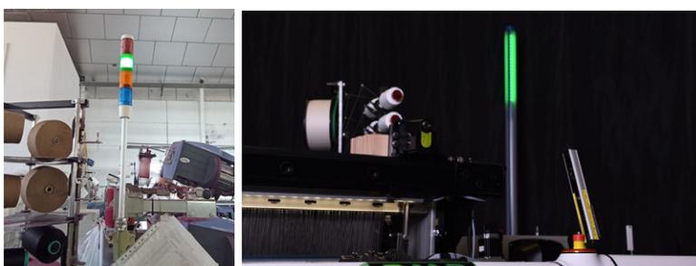
Figura 80. Sistema de indicación de errores mediante codificación de colores (Fuentes: estudio de campo, Picanol).
