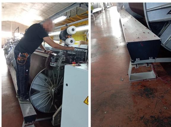
Figura 75. Altura de acceso desde la parte trasera de la máquina (Fuente: estudio de campo).
