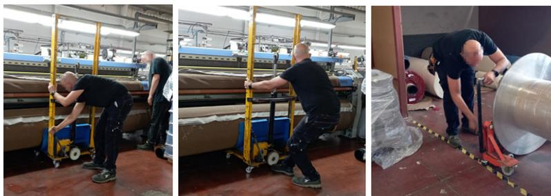
Figura 74. Manipulación manual de rollos (Fuente: estudio de campo).
