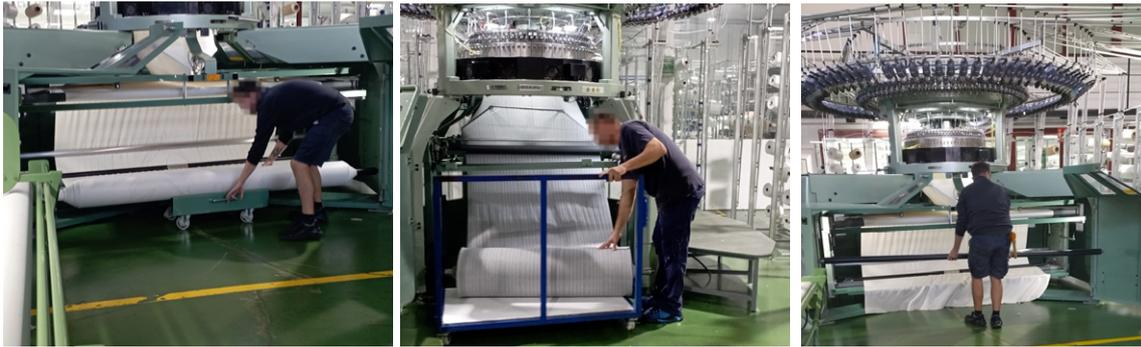
Figura 59. Manipulación manual de rollos (Fuente: estudio de campo).
