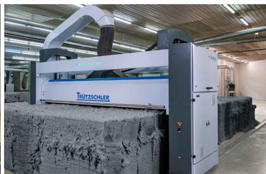
Figura 50. Abridoras de balas automáticas (Fuentes: Trützschler; Rieter).
