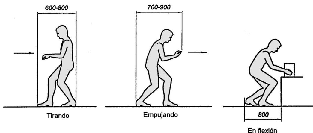
Figura 51. Espacios libres para el trabajo en máquinas (Fuente: UNE EN 14738).
