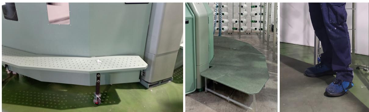
Figura 60. Diferentes tipologías de plataformas con diferentes anchos (Fuente: estudio de campo).
