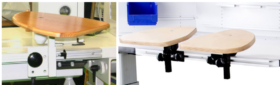
Figura 59. Reposabrazos para máquinas de coser (Fuente: INSST, 2021).
