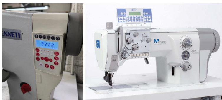
Figura 36. Diferentes ubicaciones de mandos en la máquina (Fuentes: estudio de campo, PFAFF, Dürkopp Adler).
