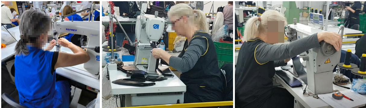
Figura 25. Altura de utilización de máquinas de columna (Fuente: estudio de campo).
