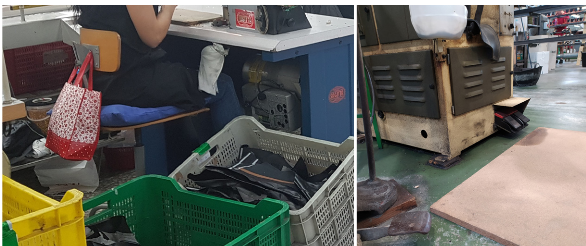
Figura 14. Espacio insuficiente para las piernas y los pies. Fuente: estudio de campo.
