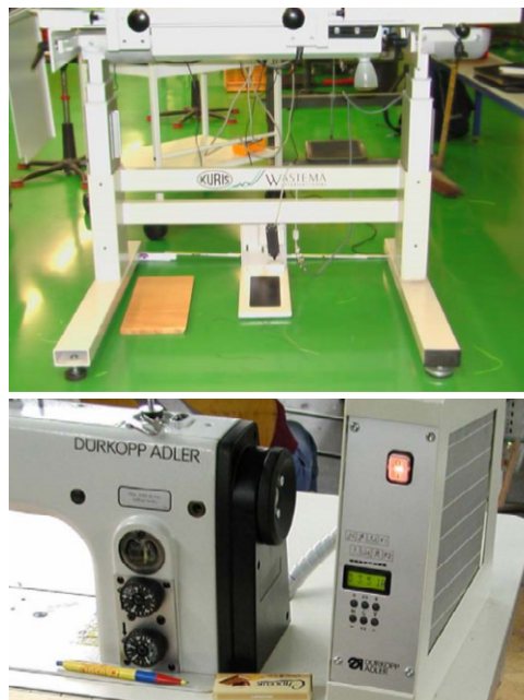
Figura 32. Mecanismo de ajuste de altura de la mesa de trabajo, y controles de ajuste (Fuente: INSST, 2021).
