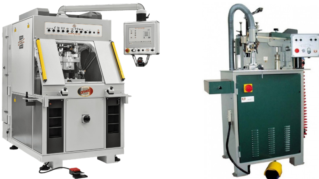
Figura 23. Máquinas de cardado automático dotadas de pedal independiente (reubicable) y sistema de mandos sobre brazo suspendido. Fuentes: Comercial Gomis, ORMAC.
