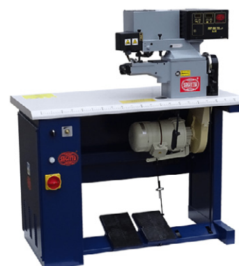
Figura 63. Máquina con soporte para pies regulable en altura (Fuente: Sagitta).
