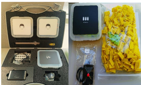
Nuevo equipo de medida de electroencefalografía (BitBrain Versatile EEG, electrodos semisecos, 32 canales)
