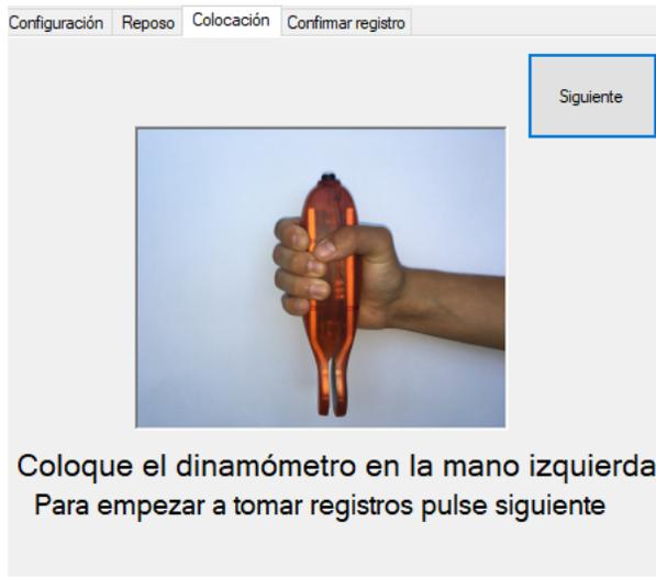
*Figura 26. Colocación correcta del dinamómetro en prueba Empuñamiento e indicación de la mano que inicia la valoración.*
